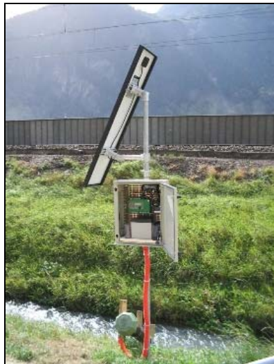
Die Multiparametersonde misst online pH, Leitfähigkeit, Wassertemperatur und Trübung und liefert die Daten an den zentralen Logger. Zusätzlich wird an 2 Messstellen der Pegel/Abfluss gemessen.
