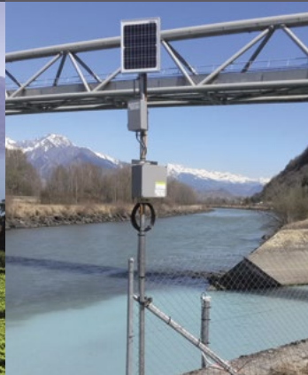
Gewässermonitoring Rhone mit innovativer LoRa- Funkdatenübertragung, Wallis (CH)
