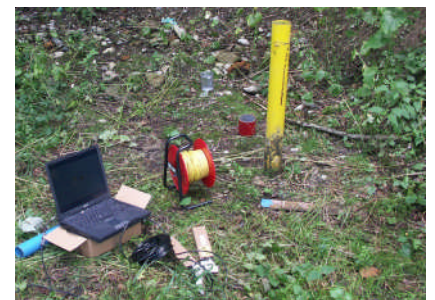
Piezomètre utilisé pour la surveillance du site et équipé d'un capteur permettant de suivre la conductivité et le niveau de la nappe
