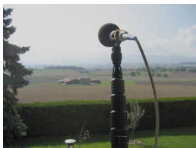
Sonomètre en place permettant de mesurer l'intensité acoustique du bruit.
