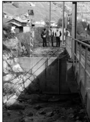
Exemple - Système d'alerte mis en place dans le cadre du concept d'alarme de Realp (Uri): redondance du signal aux points faibles par 2 radars de mesure et 1 caméra avec éclairage; acquisition d'informations à l'amont hydrologique par 2 stations pluviométriques avec mesure de la température. La transmission des paramètres depuis le terrain dans la base de données des décideurs se fait automatiquement via fibres optiques (ligne fixe) et liaison GSM.
