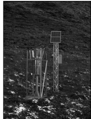
Exemple - Système d'alerte mis en place dans le cadre du concept d'alarme de Realp (Uri): redondance du signal aux points faibles par 2 radars de mesure et 1 caméra avec éclairage; acquisition d'informations à l'amont hydrologique par 2 stations pluviométriques avec mesure de la température. La transmission des paramètres depuis le terrain dans la base de données des décideurs se fait automatiquement via fibres optiques (ligne fixe) et liaison GSM.
