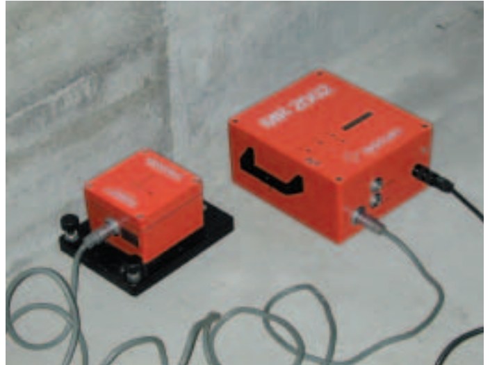
Die ökologische Baubegleitung ist verantwortlich für die Einhaltung von Umweltauflagen während den Bauarbeiten. Im Bild ein triaxiales Geophon und das zugehörige Erschütterungsmessgerät.
