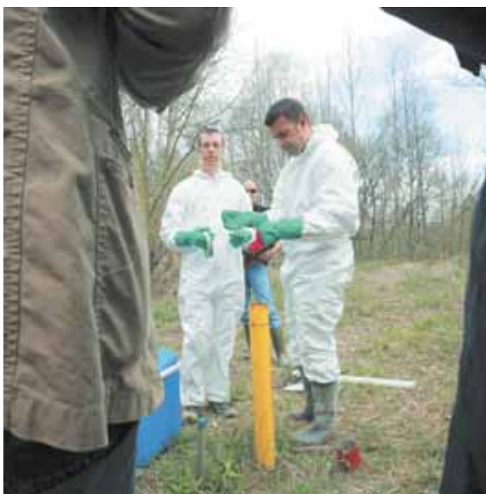
Für Proben holt die Sonde aus der Tiefe Wasser, das zwischen Erdschicht und Molasse fliesst.
