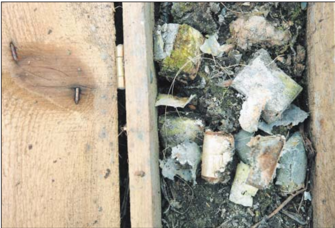
Dans un carottage, les fameux condensateurs imbibés de PCB de type dioxine. CHARLY RAPPO
