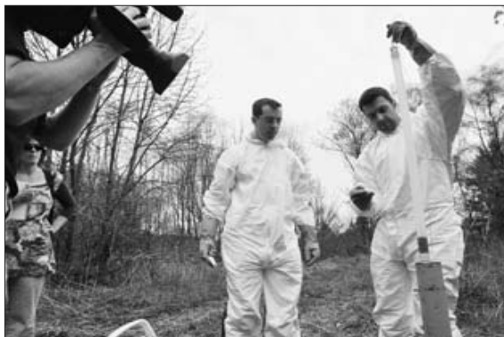
Extraites par la foreuse (à g.), les carottes révèlent le contenu de l'ancienne décharge. Le trou sert ensuite à prélever des échantillons d'eau souterraine
