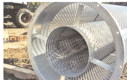
Abb. 2: Bodenzüstfilter DN 800 mit Stahlfilterrohr DN 300 (Ausbaumaterial für oberen Filter des Grundwasserzirkulationsbrunnens).
